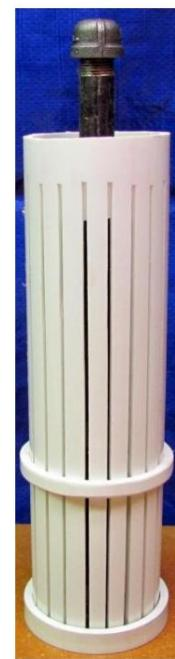
$\frac{1}{2}$  "검정 철 파이프 용 주철 바닥 플랜지는 3 인치 75mm 일정 40 PVC 파이프 내부에 잘 맞습니다. 센터홀이 필요 없는 브리켓용 플랜저로 사용 가능합니다. 약간 해야 할 수도 있습니다 여유 공간을 위해 플랜지의 둘레를 연마하십시오.  $\frac{1}{2}$ " 파이프 끝에 있는 엔드 캡은 날카로운 모서리로 인해 프레스와 손가락이 손상되지 않도록 보호합니다.
