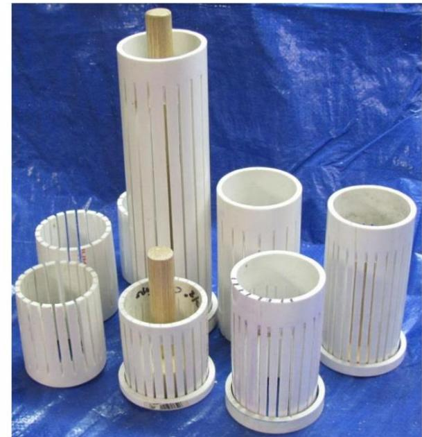
수직 슬롯 배수는 천공된 구멍을 사용하는 기존 PVC 몰드에 비해 연탄에 더 적은 배출 응력을 제공하고 더 적은 배출 힘을 필요로 합니다(일반적으로 손으로 배출), 연탄이 배출됨에 따라 자체 청소됩니다. 이 구성을 사용하면 일반적으로 브리켓을 배출하는데 프레스가 필요하지 않으므로 프레스가 이전 브리켓을 배출하는 대신 다음 몰드를 즉시 압축할 수 있으므로 더 빠른 처리가 가능합니다.
